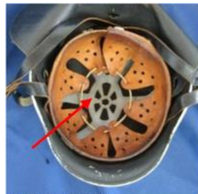
Bild 1: Helm mit Kunststoffeinsatz Quelle: atemschutzunfaelle.eu
